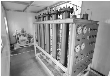
图 7 水溶氦气提纯设备
