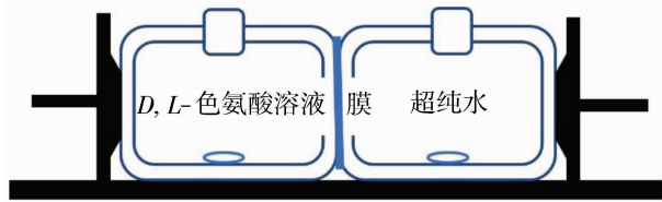
图 2 手性拆分透析器装置图
