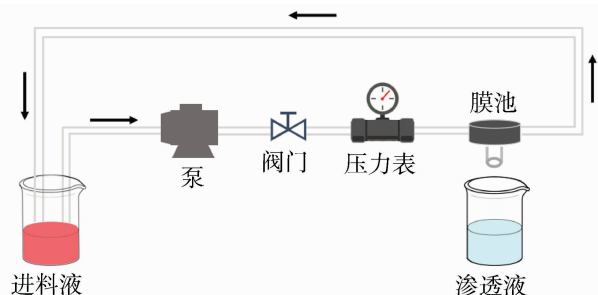
图2 过滤装置示意图
