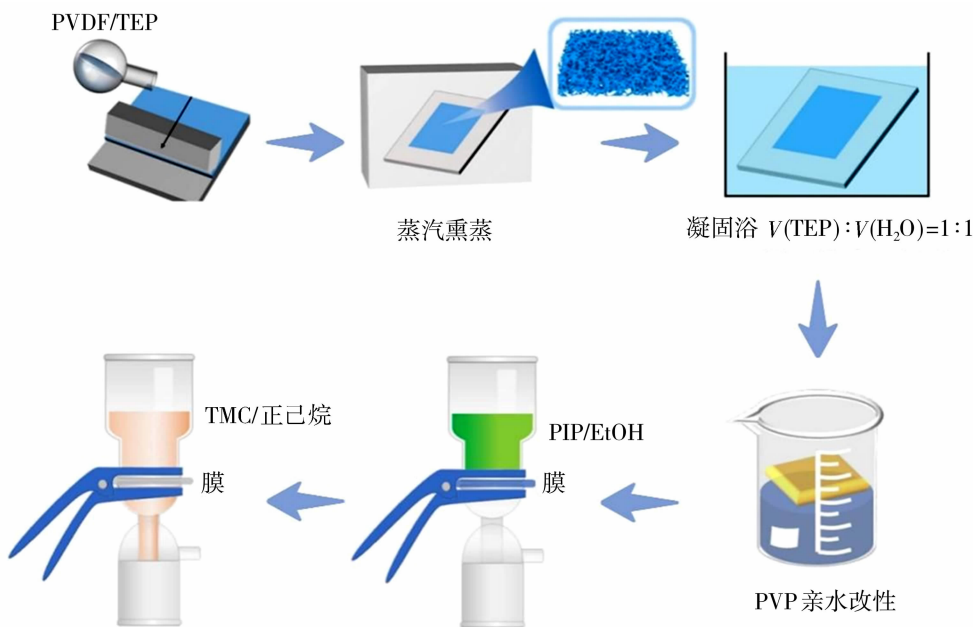
图 1 PVDF 膜制备、亲水改性及聚酰胺层构筑过程流程图
