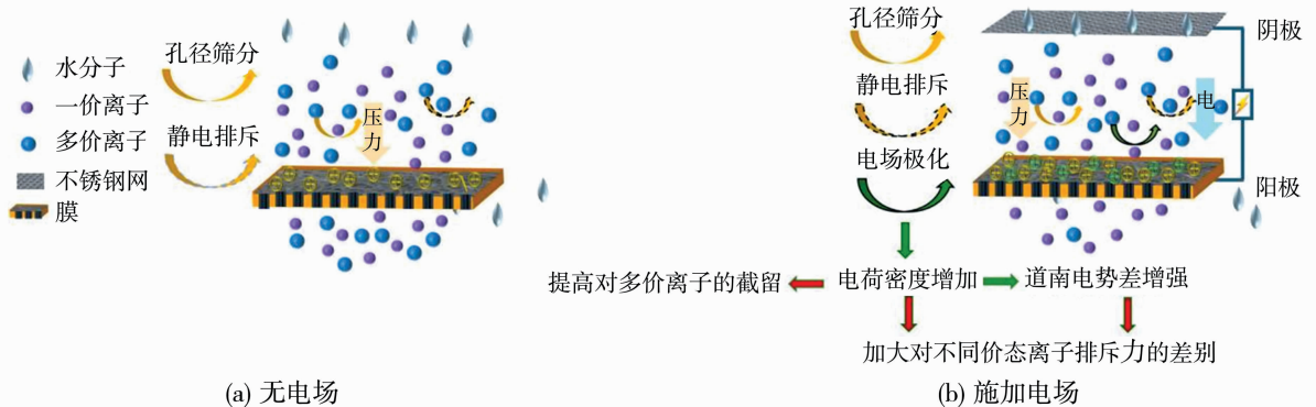
图 16 \text{Cu}^{2+} 截留和 \text{Na}^+/\text{Cu}^{2+} 选择性分离机理
